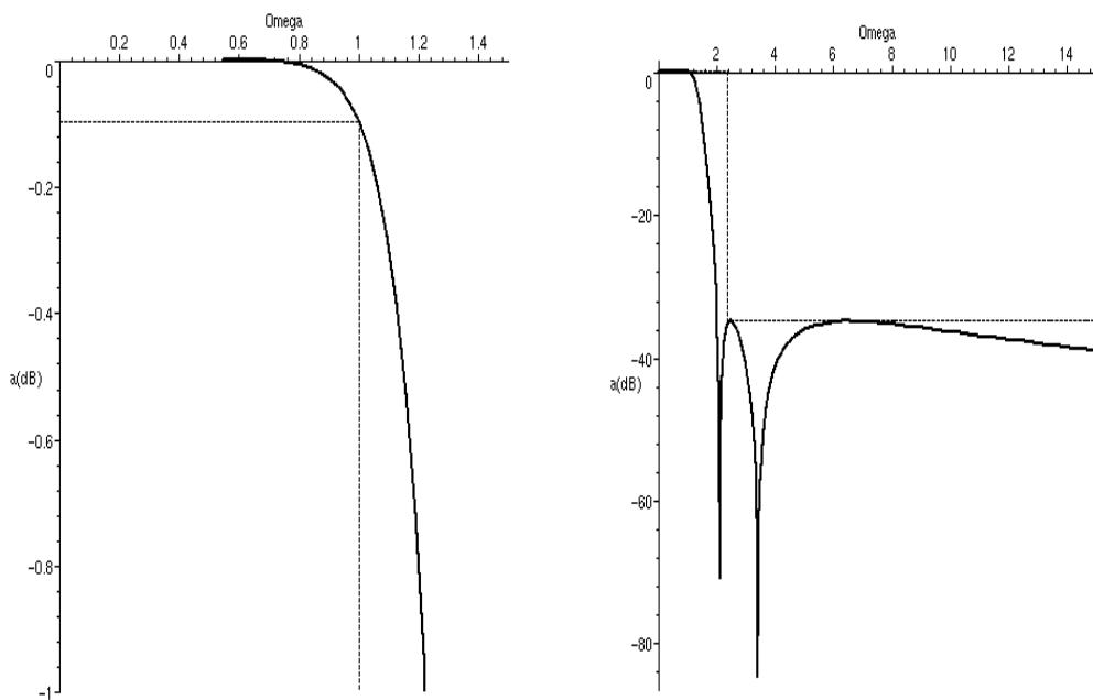
Detail přenosové charakteristiky propustného a nepropustného pásmá
