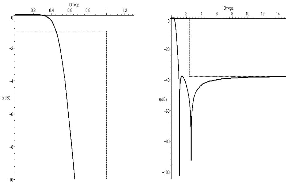
Detail přenosové charakteristiky propustného a nepropustného pásma
