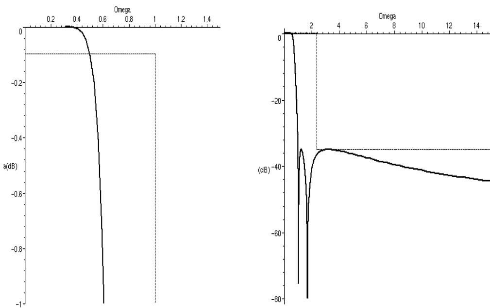
Detail přenosové charakteristiky propustného a nepropustného pásmá
