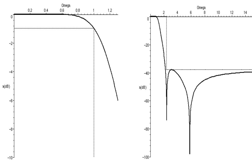
Detail přenosové charakteristiky propustného a nepropustného pásma
