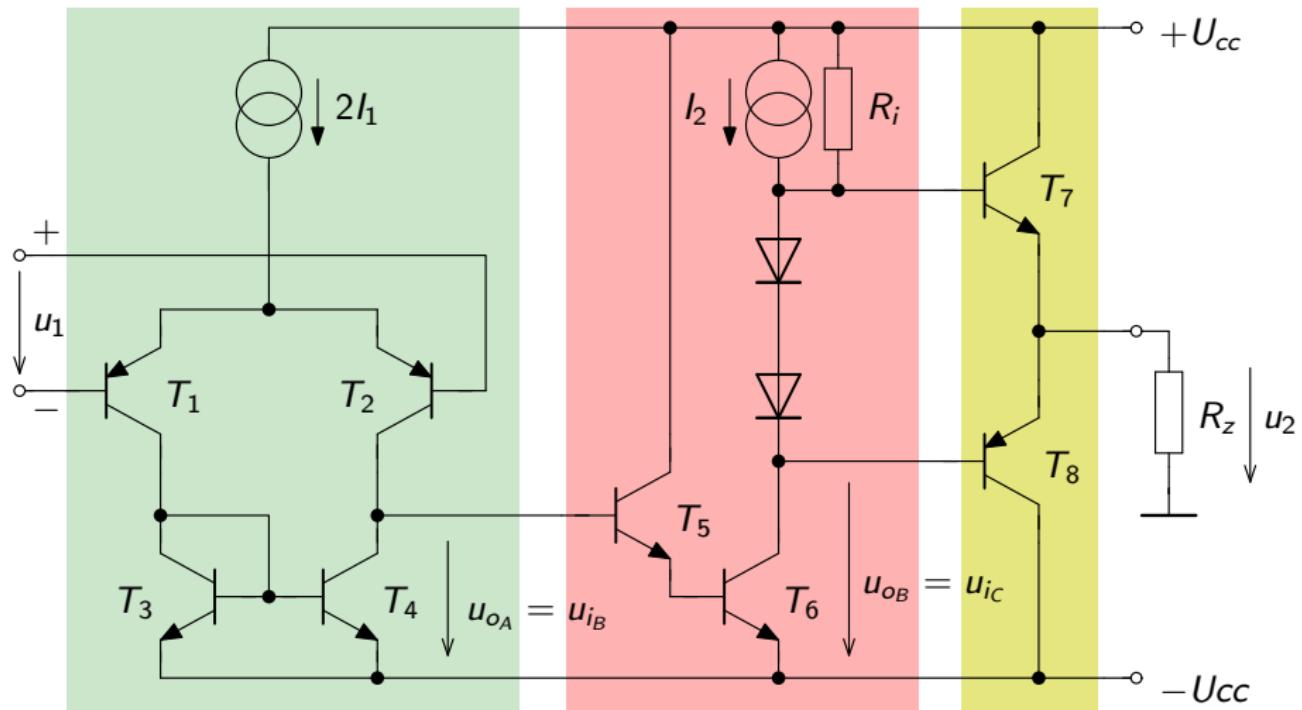
Vstupní část , rozkmitový a koncový stupeň
