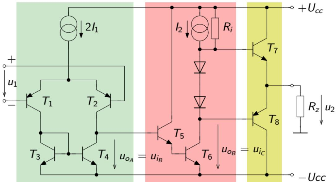
$$I_1 = 6,4 \mu\text{A} \Rightarrow r_{e1} \doteq 4\text{k}\Omega, r_{\pi 1} \doteq 300\text{k}\Omega, r_{oA} \doteq 8 \text{ M}\Omega$$
